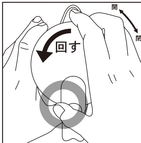
フタを開閉する際は、ツマミの付け根を支点として本体を支えながら、回して開閉してください。また、閉め過ぎますと開けにくくなりますので、ご注意ください。
